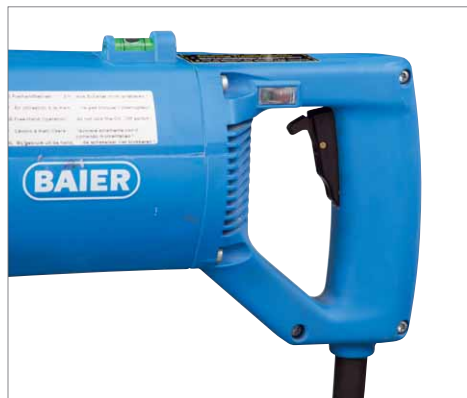
Der Gasgriff darf im Freihandbetrieb aus Sicherheitsgründen nicht arretiert werden
