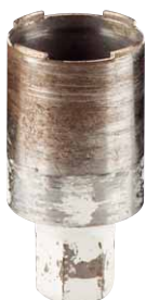
Die „kleine“ Diamantbohrkrone hat einen Durchmesser von 82 Millimetern und eine Länge von immerhin schon 100 Millimetern
