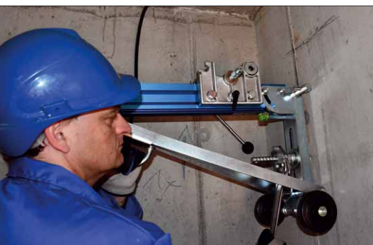
Die Maschine kann auch mit einem Bohrständer betrieben werden, der sowohl für horizontale als auch für vertikale Bohrungen geeignet ist. Dafür wird der Bohrständer zum Beispiel an eine Wand geschraubt, ...
