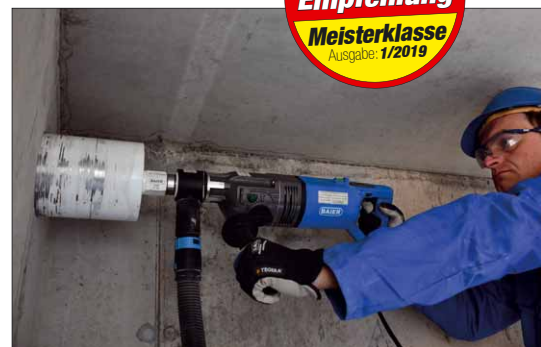
Da die Maschine über eine Schnellabschaltung verfügt, sind Freihandbohrungen auch kein Problem
